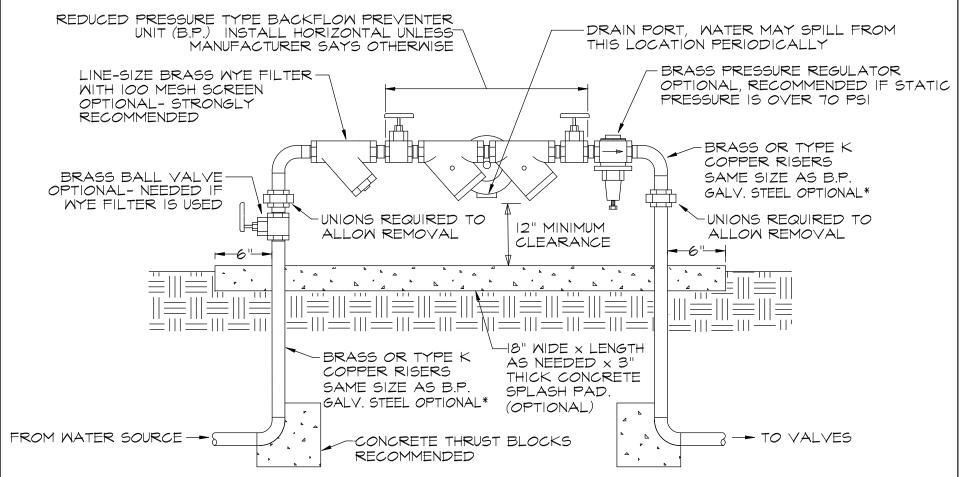
BACKFLOW PREVENTER SHOULD BE TESTED AND CERTIFIED AFTER INSTALLATION BY A CERTIFIED BACKFLOW PREVENTER TECHNICIAN.
