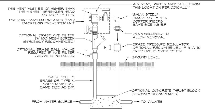
BACKFLOW PREVENTER SHOULD BE TESTED AND CERTIFIED AFTER INSTALLATION BY A CERTIFIED BACKFLOW PREVENTER TECHNICIAN.
